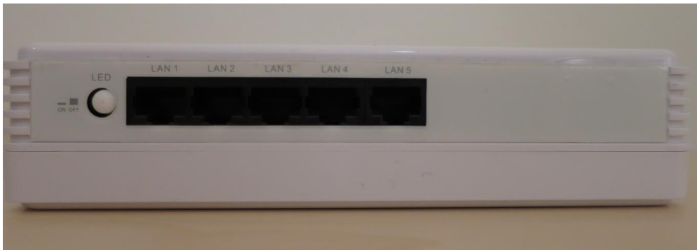
Bild. CPE sedd underifrån, LAN-uttag 1 till 5, RJ45-kontakter.
