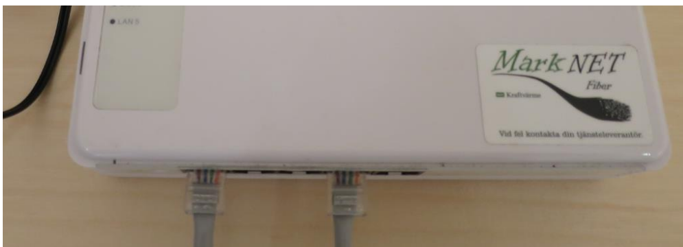
Bild. CPE sedd framifrån, med anslutna datakontakter i
